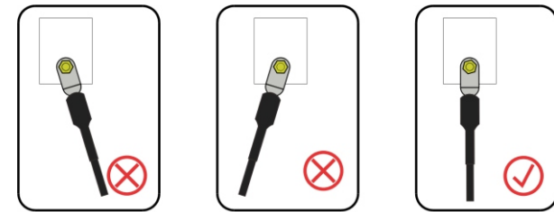
Bild 5-5 Se till att kablarna är parallella
